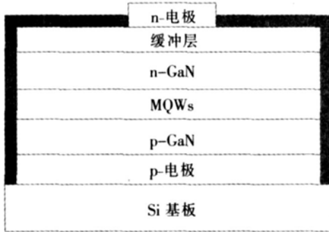
图 1 实验用的 GaN LED 芯片结构示意图
